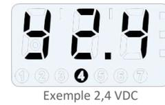
Les carrés à l'extrême droite de l'écran indiquent l'unité sur laquelle le servomoteur est réglé : l/s, m<sup>3</sup>/h & cfm (m<sup>3</sup>/h par défaut).
