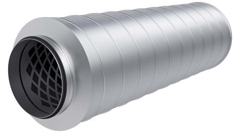
Galvanisierter Rohrschalldämpfer für die Installation in runden Luftleitungen. Das Gehäuse besteht aus einem Wickelfalzrohr als Mantel, mit einer perforierten Stahlplatte an der Innenseite. Als Dämmstoff wird 50mm Mineralwolle verwendet. Das Polyestertuch zwischen Innenmantel und Dämmstoff verhindert das Eindringen von Mineralwolle in der Luftleitung. Falls eine größere Schalldämmung erforderlich ist, können ggf. mehrere Schalldämpfer hintereinander montiert werden.
